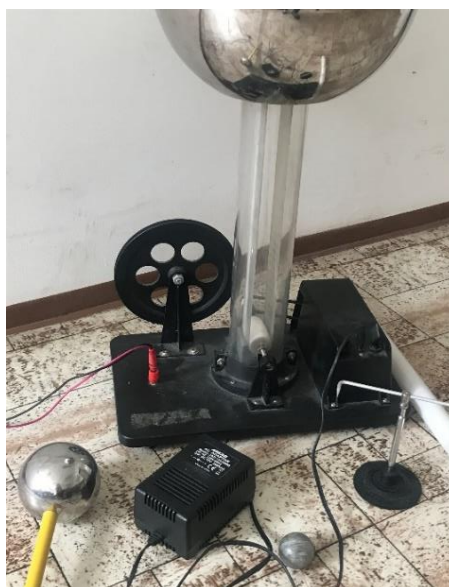
Fig. 1. Van de Graaff generator for basic experiment
